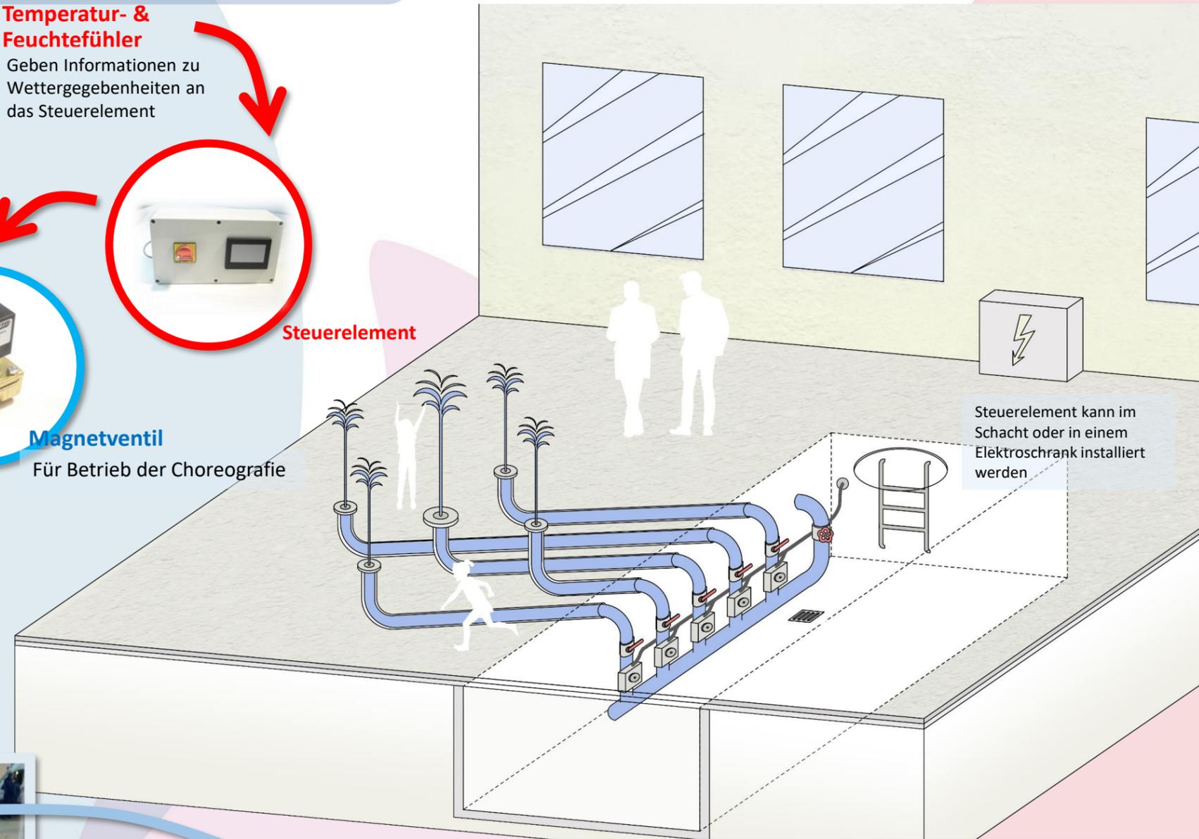
Steuerelement kann im Schacht oder in einem Elektroschrank installiert werden
