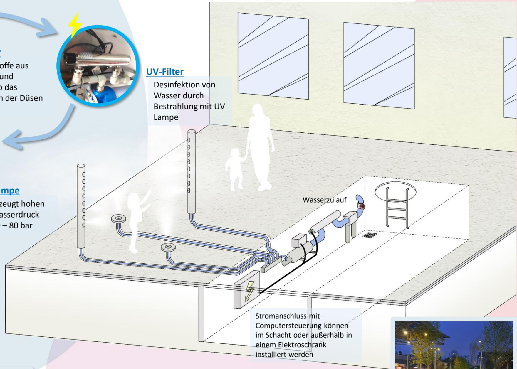
Stromanschluss mit Computersteuerung können im Schacht oder außerhalb in einem Elektroschrank installiert werden
