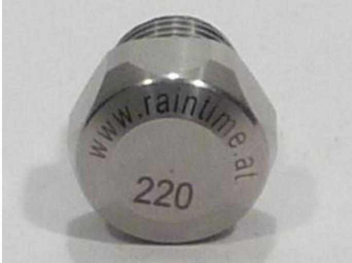
Hochdrucknebeldüse Edelstahl: Düsenöffnung 220µm Standard G 1/8", mit oder ohne Tropfstopp, Verbrauch: 4,20 l/h bei 70bar
